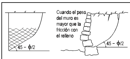
Fig. 23. Derrumbe de suelo no cohesivo apoyado en el muro. Condición parcial pasiva.
